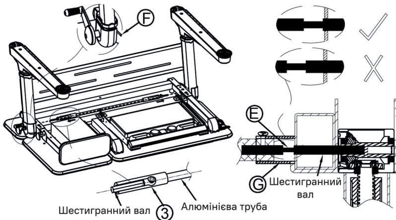
Спочатку послабте гвинт з одного боку шестигранного валу. Потім вставте вал в трубу збоку, щоб він ввійшов до відмітки E, як показано на схематичному малюнку. Якщо вал не входить до потрібної відмітки, то вставте в отвір ноги ручки і прокрутіть її (F). Так само вставте шестигранний вал з іншого боку, посуňte пластикові рукави до обох кінців валу і затягніть гвинти.
