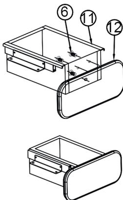
Прикрутіть дерев'яну панель(12) до ящика(11) за допомогою гвинтів(6).
