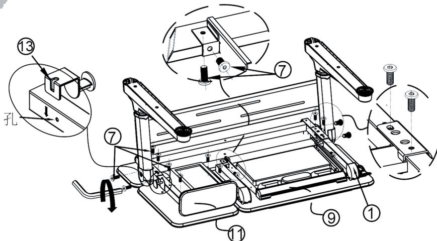
Встановіть ноги столу з перемичкою на стільницю(1) і закрутіть гвинтами(7). **Примітка:** щоб ноги щільно прилягали до рами, спочатку вкрутіть гвинти збоку, а потім гвинти зверху. Вставте гачок(13) у раму з правого боку стільниці і закріпіть гвинтами(7). Встановіть ящик(11) і органайзер(9) на рамі стільниці, закріпіть гвинтами(7). **Зверніть увагу:** спочатку закріпіть гвинти у нижній частині органайзера, переверніть стіл, потім затягніть чотири гвинти.
